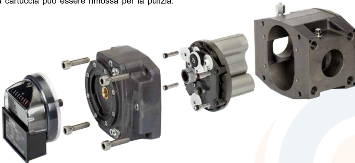
L'utilizzo di una cartuccia (precalibrata) e l'accessibilità dei cuscinetti anteriori e posteriori senza la necessità di smontare gli ingranaggi di distribuzione, rendono la serie di contatori FMG unica in termini di riparazione. Qualsiasi officina può riparare o ri-condizionare i contatori senza particolari competenze e strumenti. Quando la regolazione lo consente, può essere installata una nuova cartuccia calibrata.
